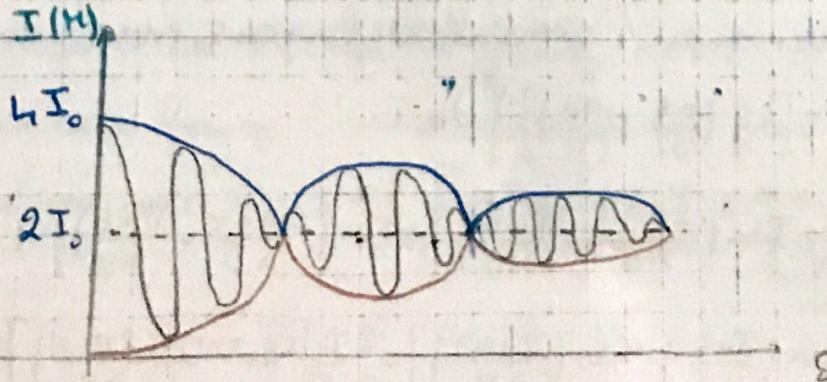
I éclairé par une source monochromatique fixe de fréquence  $\nu$
